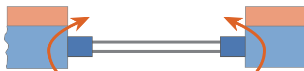
Konstruktionsbedingte Wärmebrücke mit seitlich entweichendem Wärmestrom
